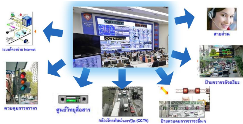
รูปภาพที่ ๒.๑ แนวคิดการจัดการควบคุมสัญญาณไฟจราจรแบบ Area Traffic Control หรือระบบ ATC
