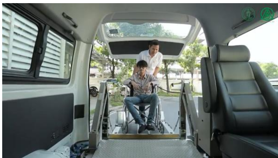
รูปที่ ๓ แสดงลิฟท์ที่แข็งแรงที่สามารถยกน้ำหนักได้ถึง ๒ คนในเวลาเดียวกัน
