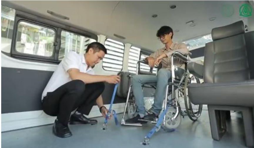
รูปที่ ๔ แสดงพนักงานขับรถกำลังยึดเก้าอี้ผู้พิการเข้ากับหมุดยึดที่นั่ง ๔ มุม
